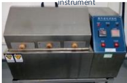
蒸汽老化测试仪 スチームエージングテスター/Steam aging
